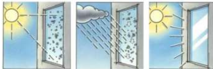
( صورة 8 أ ، ب ، ج ) توضح قطرات الماء المكثفة وامكانيات الزجاج ذاتى التنظيف المعالج بخاصية ( Photo catalysis ) على التخلص الدائم منها وبشكل فوري . Sylvia,leydecker,Nanomaterials in architecture, interior architecture and design,Princeton Architectural Press, NY, USA, 2008.
